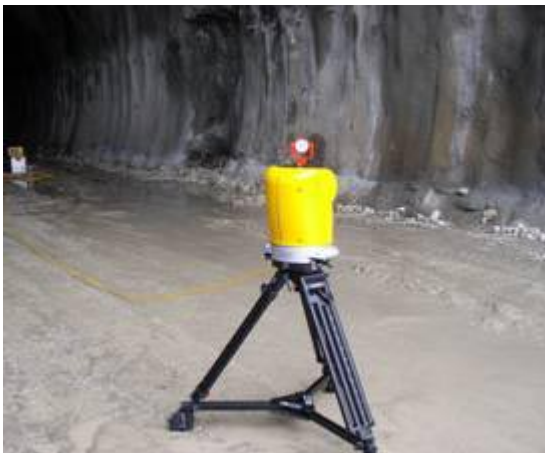
Σχήμα 1: Αποτύπωση σήραγγας με 3D Laser scanner Figure 1: 3D Laser scanner during tunnel survey
